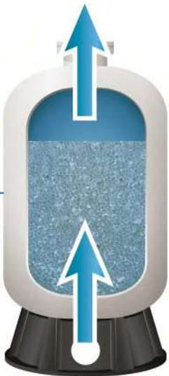
7. Retrolavar el filtro con la velocidad de diseño del equipo por **5 a 10 minutos**.
