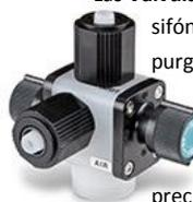
Las **Válvulas multifunción** proveen anti sifón, contra presión, alimentación, purga y alivio de presión para las bombas dosificadoras Clase E. Estas válvulas previenen el efecto sifón incrementando la precisión y la repetitividad en aplicaciones con poca o ninguna presión Se ofrecen en PVDF, PTFE y Aflas™.
