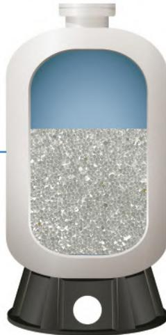
3. Rellenar el tanque con **SiLibeads**® Grado 3 (o grava de soporte) hasta cubrir el difusor inferior por 2 pulgadas.
